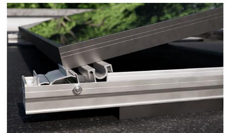
Module mit einer Breite zwischen **1035 mm und 1070 mm** werden am unteren Aluminiumprofil angelegt, wobei die Kunststofflippe weggedrückt wird. Für Module mit einer Breite zwischen **1071 mm und 1150 mm** ist ein spezielles Teil erhältlich.
